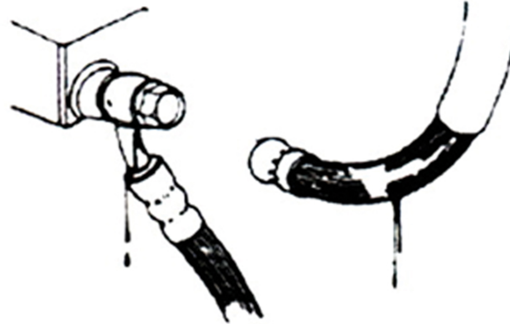
نشتی، آسیب دیدگی یا شل بودن اتصالات
