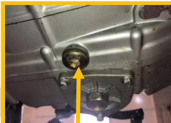
پیچ تخلیه روغن در زیر انجین
